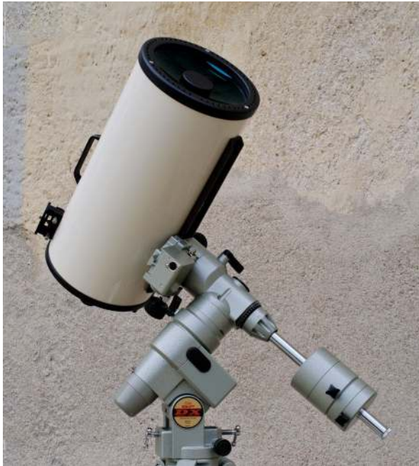
Ilustración 11: Telescopio sobre montura ecuatorial alemana. Fuente: Marie-Lan Nguyen, Wikimedia Commons, bajo licencia CC BY 2.5.
